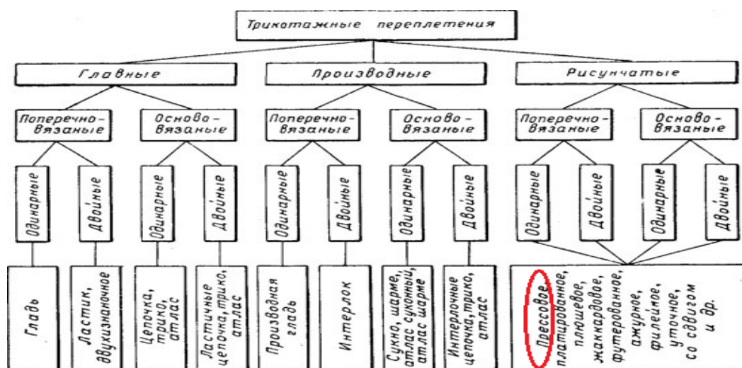
Рис. 1. Классификация прессовых переплетений
