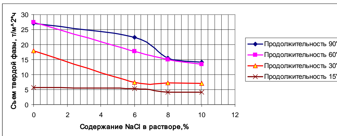
Рис. 1. Зависимость производительности фильтрования по твердой фазе от концентрации хлорида натрия в растворе (норма соды 115 % от стехиометрии, температура 140 °С)
