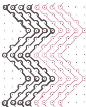
Рис. 2. Структура переплетения атлас
